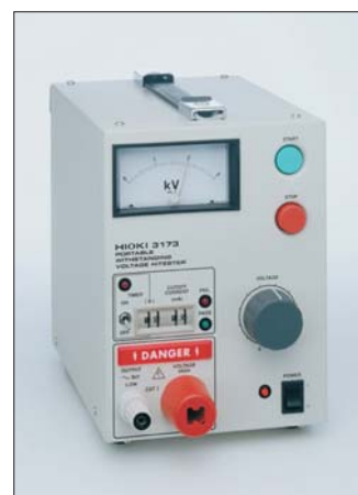
Fot. 1 Tester wytrzymałości izolacji HIOKI 3173-03
