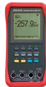
Fot. 2. HDS-6102 przy pracy w trybie multimetru cyfrowego.
