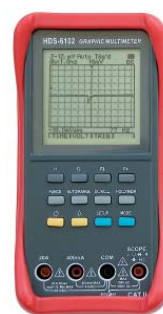
Fot. 1. HDS-6102 przy pracy w trybie oscyloskopu cyfrowego.
