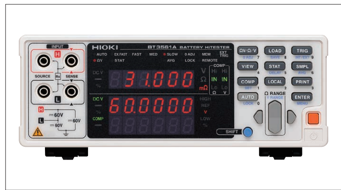
Fot. 1. Laboratoryjny tester akumulatorów HIOKI BT3561A
